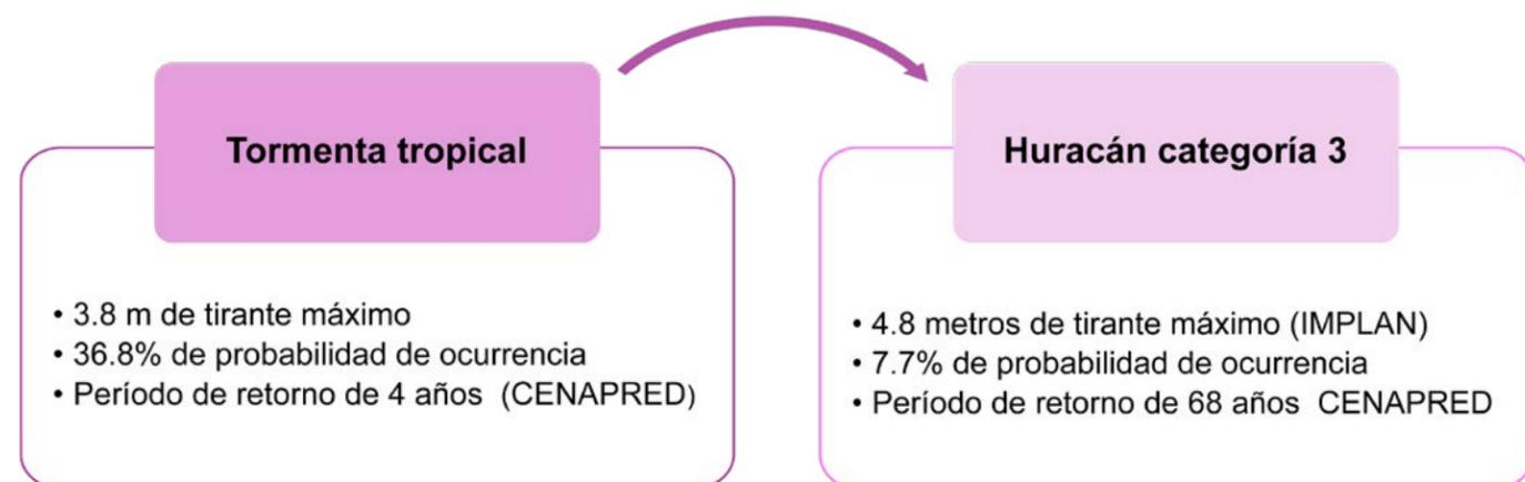
Figura 41. Modelo de peligro de inundación por marea de tormenta en escenarios extremos. Fuente: IMPLAN 2024
